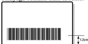
Pour utiliser le scanner à fente dans les meilleures conditions, les codes barres doivent être imprimés ou appliqués de telle manière que le centre du code se trouve à 1,27 cm du bord du support.
